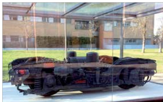
Monument dedicat als treballadors de Can Girona que es va instal·lar el 2015 a la plaça de Ramon Calsina. És un bogie, un carretó articulat.
